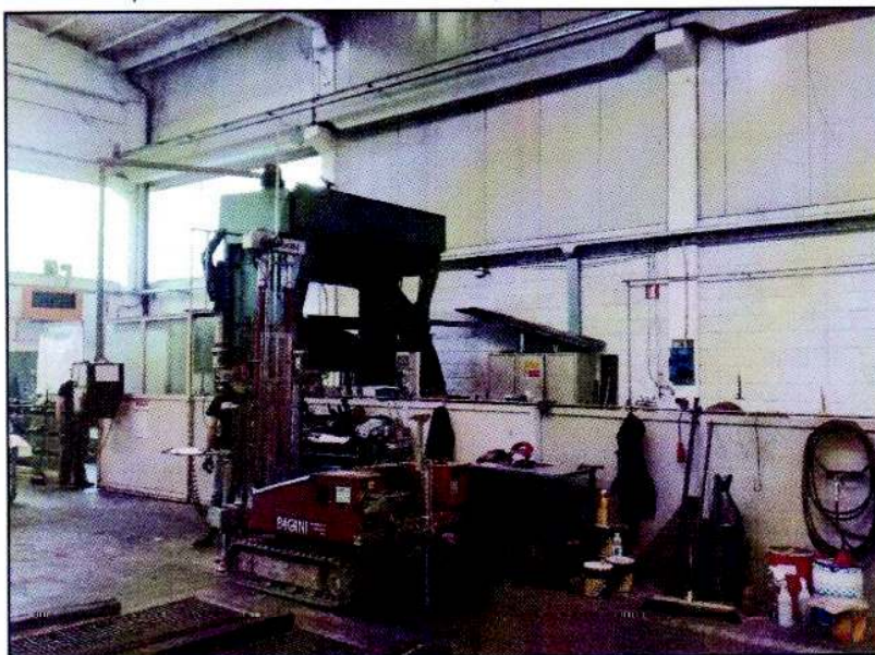
Figura 5: esecuzione prova penetrometrica dinamica n. 1
